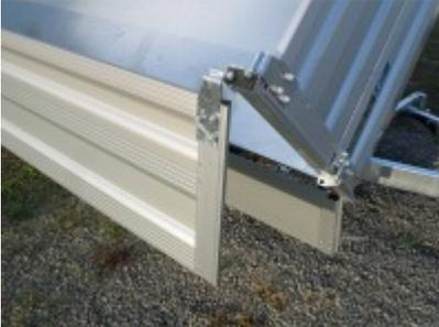
Sondermodell Plus 55 incl. 550 mm Unsinn Profil Alubordwandaufsatz ( zzgl 82kg Gewicht bei Nutzlast beachten) **Hydraulik:** E Hydraulik mit Batterie und Ladegerät, Notpumpe Pumpless für Akkuschauber Klappbarer Kennzeichenhalter für Verstauen der Auffahrschienen unter der Lagefläche
