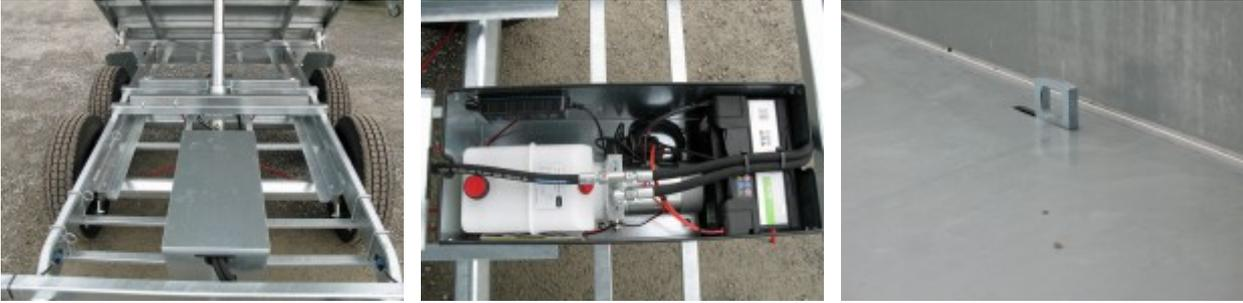
**Hydraulik:** E Hydraulik mit Batterie und Ladegerät, Notpumpe Pumpless für Akkuschauber Klappbarer Kennzeichenhalter für Verstauen der Auffahrschienen unter der Lagefläch Vorbereitung für Auffahrschienenhalterung
