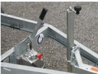
Ein-Achser Rückwärtskipper mit Hydraulikzylinder und Handpumpe
