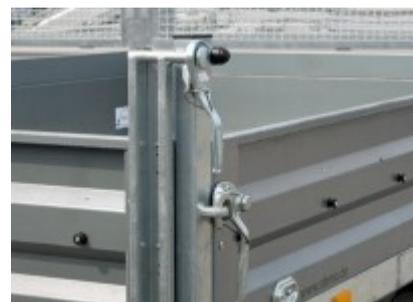
2 mm Stahlbordwände Tandem-Hochlader mit V-Deichsel
