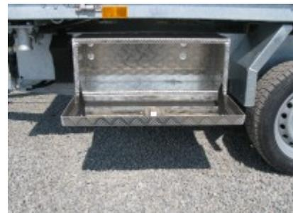
Mit soliden Haltebändern ausgestattet, Regen und Spritzwasser geschützt durch umliegende Dichtungen im Deckel und mit einem Schloss inkl. 2 Schlüsseln ausgestattet.
